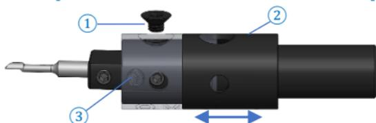
1. Deserrer la vis à tête fraisée ① et déplacer la douille ② (Attention : retenez le ressort avec vos doigts)
