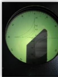
Pour les alésages proches des parois, l'outil doit être réglé à l'aide de l'arête de transition entre l'arête de coupe intérieure et extérieure afin qu'il ne heurte pas la paroi!
