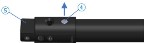
2. Extraire la goupille cylindrique ④ dans le sens de la flèche et retirer l'insert ⑤.
