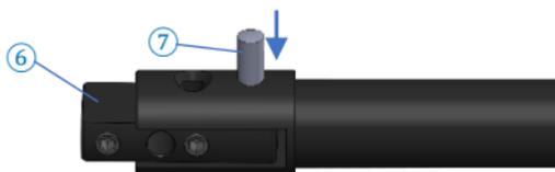
3. Insérer un nouvel insert ⑥. Attention à l'orientation. Graisser légèrement l'axe. Sortir la nouvelle goupille cylindrique ⑦ de l'emballage d'origine et insérez-le dans le sens de la flèche.
