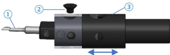
1. Retirer l'outil de coupe ①, desserrer la vis à tête fraisée ② et la Détacher la douille ③. (Attention : retenez le ressort avec vos doigts)
