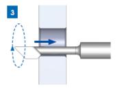
Nur so weit eintauchen, bis das Werkzeug nach außen ausschwenkt und der abgesetzte Werkzeughals an der Bohrung anliegt. Dann mit geringem Vorschub, abhängig von der gewünschten Entgratintensität, aus der Bohrung zurückfahren. Dabei wird der Grat entfernt, da die Schneide durch die Federkraft an die zu entgratende Kante gedrückt wird. Sobald die Schneidfläche frei ist, im Eilgang aus der Bohrung herausfahren.
