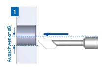
Mittelachse des Entgraters auf Mitte der Bohrung positionieren. Ausschwenkmaß so einstellen, dass die Mitte der Schneide auf die Bohrungskante trifft. Das Werkzeug wird entgegen der Federkraft zur Achse gedrückt.
